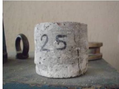
Şekil 6: Karot numunelerin basınç deneyi
