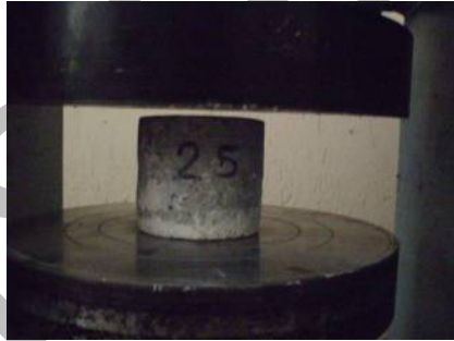
Şekil 6: Karot numunelerin basınç deneyi
