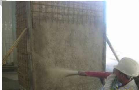
Şekil 4: Tuğla duvar numunesine püskürtme beton uygulanması
