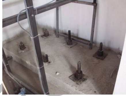
Şekil 8: Numune temelinin rijit döşemeye sabitlenmesi
