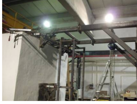
Şekil 9: Deney numunesinin döşeme ve hatıl seviyesinden sabitlenmesi
