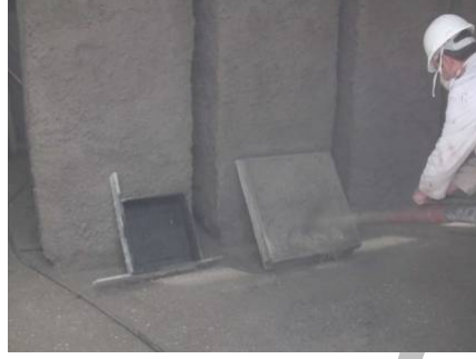
Şekil 5: Deney panellerine püskürtme beton uygulanması
