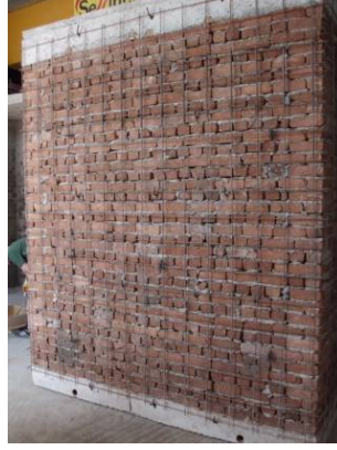
Şekil 3: Hasır çelik yerleştirilmiş numunenin görünümü
