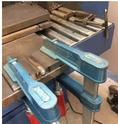
Şekil 1. Kaynak işlemi öncesi sabitlenmiş MIL A 46100 plakaları
