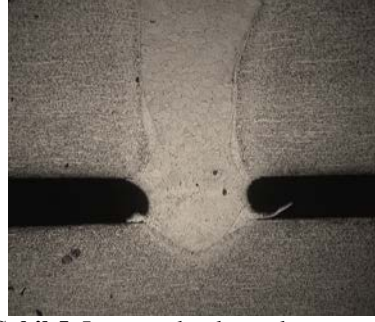
Şekil 5. Lazer nokta kaynak yöntemiyle kaynatılmış AISI 430 paslanmaz çelik
