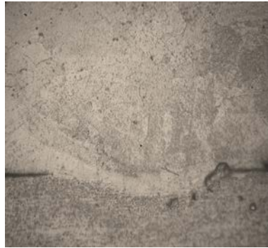
Şekil 6. Tam temas halinde lazer nokta kaynak
